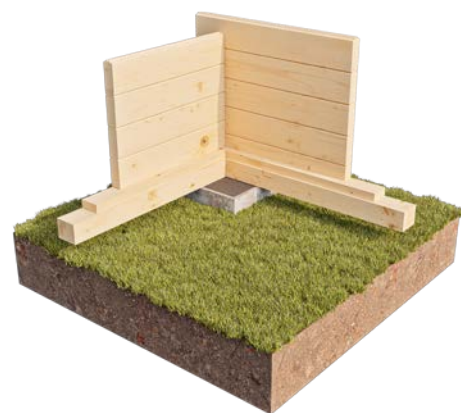
Фундамент из полнотелых цементно-песчаных блоков.
