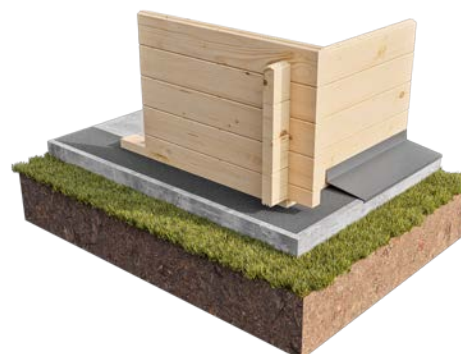
Фундамент в виде сплошной плиты.
