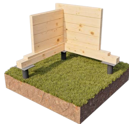
Свайный фундамент с деревянным обвязочным ростверком.
